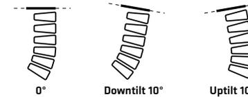
Mit Uptilt/Downtilt wird der maximal erlaubte Steigungs- und Neigungswinkel des Flugrahmens bei der entsprechenden Konfiguration nach oben bzw. unten beschrieben.
