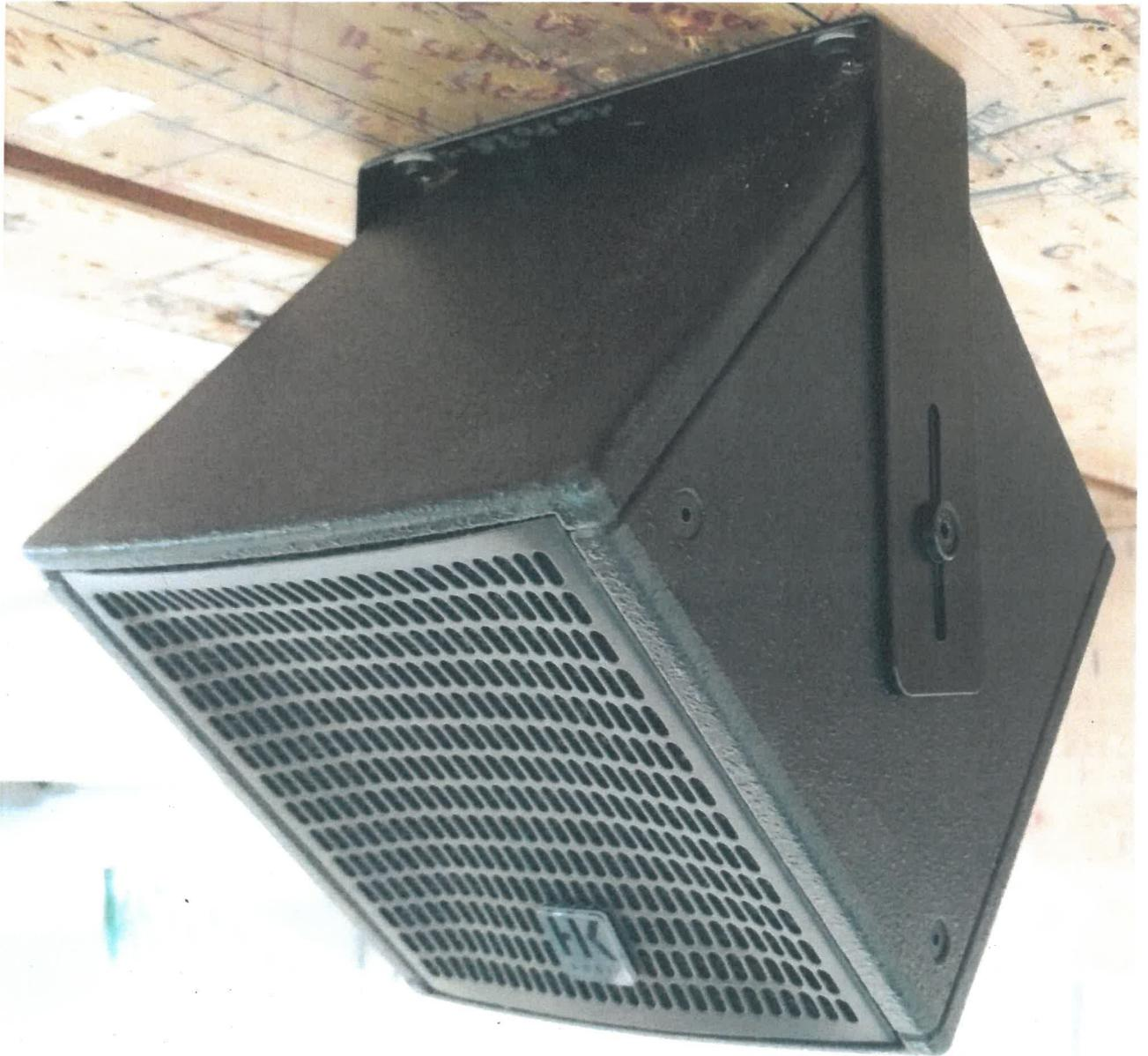
Bild 2: Detail Verformungen Frontgitter nach Prüfung
