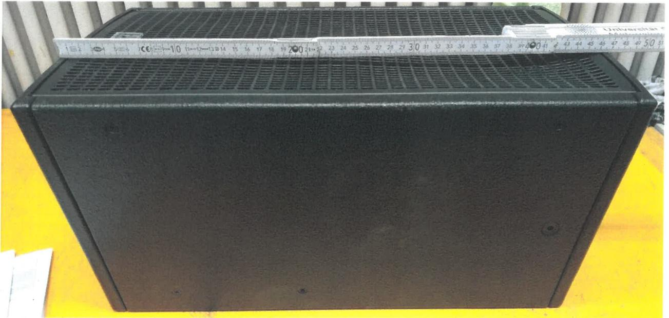
**Bild 2: Detail Verformungen Frontgitter nach Prüfung
