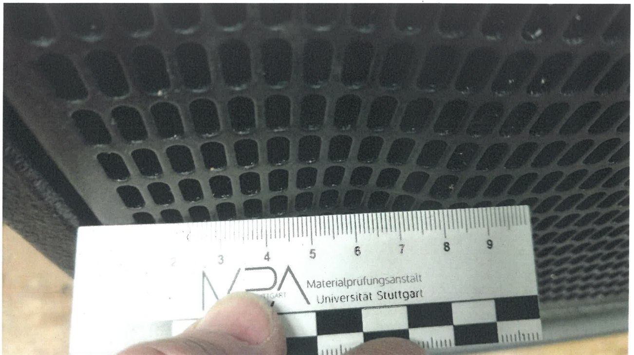
Bild 2: Detail: bleibende Verformung durch Beschuss „Lautsprecher FINEO FO S118 (1008003)“
