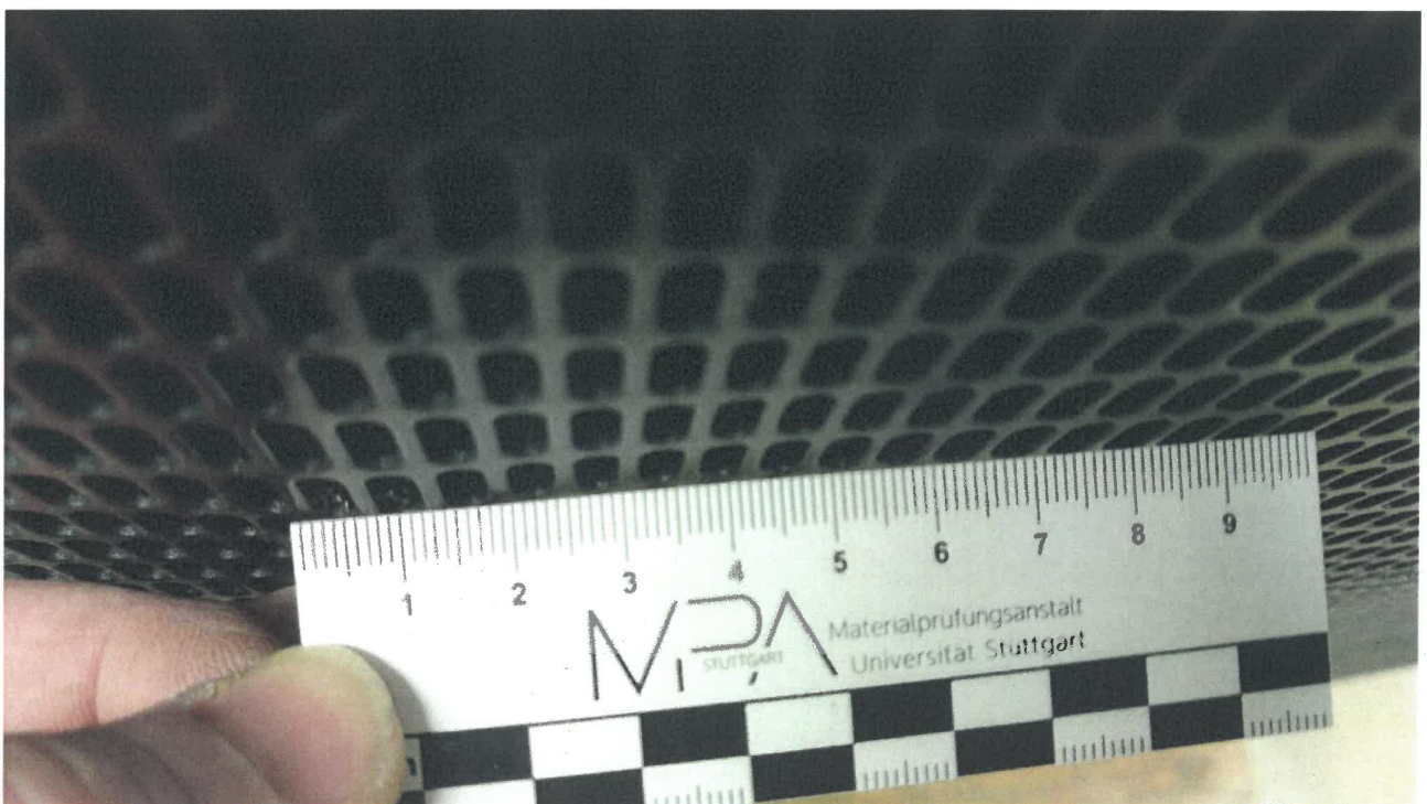
Bild 2: Detail: bleibende Verformung durch Beschuss „Lautsprecher FINEO FO S218 (1008004)“
