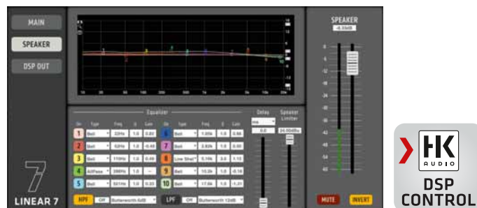
Screenshot del software remoto DSP CONTROL, disponibile gratuitamente nell'area download dei prodotti LINEAR 7 su www.hkaudio.com . I parametri per "Speaker" e "DSP Out" sono identici, ma possono essere configurati indipendentemente grazie alla doppia potenza DSP.
