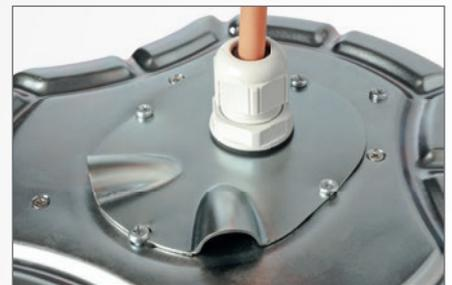
Standardmäßig sind zwei 2-pol-Euroblock-Stecker im Lieferumfang enthalten. Die Anschlusskabel können mit Abdeckplatten mit gewölbtem Auslass geführt werden oder – je nach Anforderung – auch mit einer PG-Verschraubung befestigt werden. Beide Arten von Abdeckplatten sind ebenfalls im Lieferumfang enthalten.
