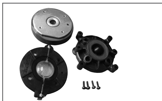
Abb. 38: Demontierte Schwingspule des CAD 208 Hochtontreibers
