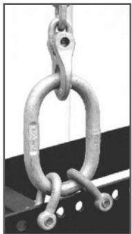
Abb. 14: Realisierung eines „Zwischenwinkels“ zum Gesamtcurving
